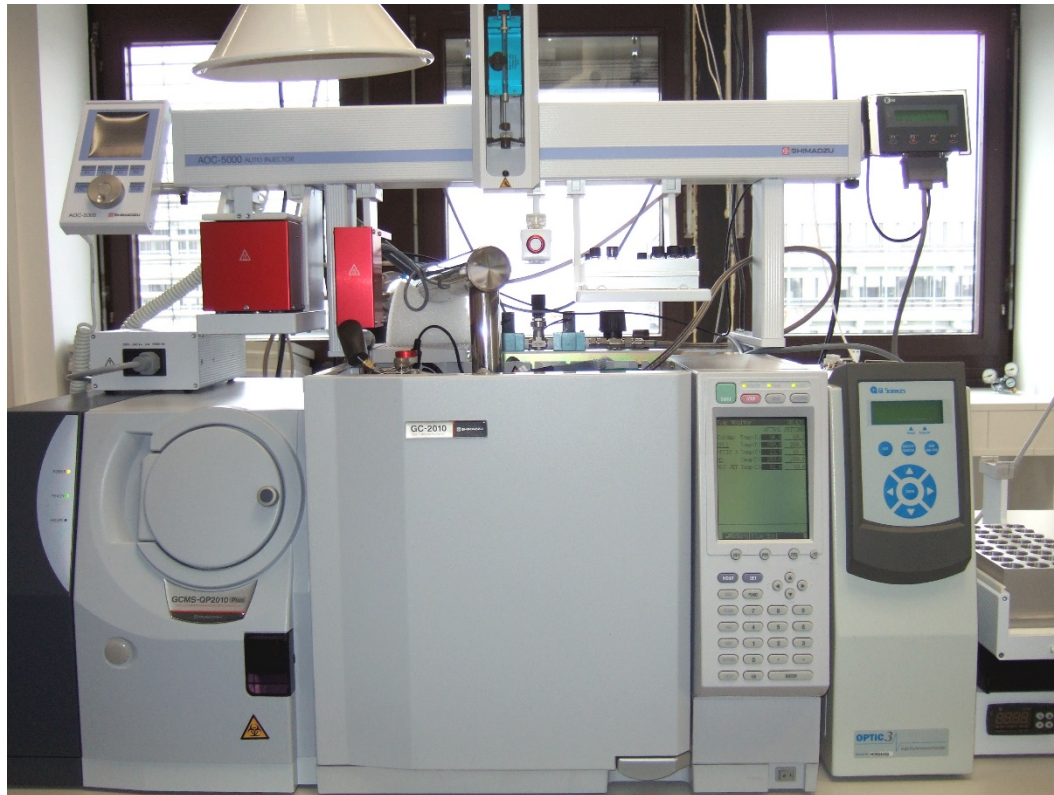
Shimadzu GCMS-QP-2010Plus, mit Optic3-PTV Injektor mit LN2-Kühlung, Split/Splitless-Injektor, Zoex Modulator für GCxGC mit Kompressorkühlung, CTC CombiPAL Autosampler
